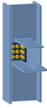
Figura 86 – Connessione a squadretta HEB300c
